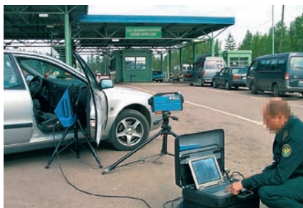
Работа с переносным рентгентелевизионным комплексом «Шмель-240ТВ»
